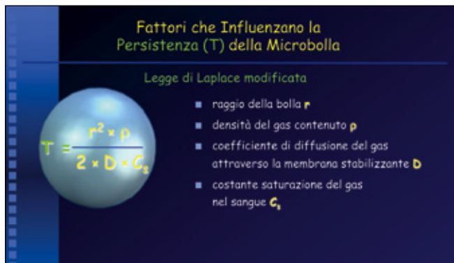
Fig. 5 - Non essendo possibile modificare il raggio della microbolla, (mancato passaggio attraverso il filtro trans-polmonare, diametro ~ 6 mm, e frequenza di risonanza a valori sotto 1 MHz), si modifica il gas in essa contenuto. La scelta, pertanto, ricade su un gas poco diffusibile, inerte, più denso e meno solubile in acqua rispetto all'aria.
