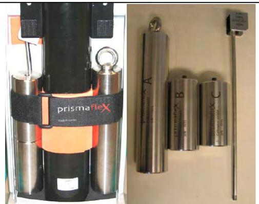
Per effettuare la procedura di calibrazione delle **BILANCE**, occorre **assemblare i componenti A e B** del Kit pesi di calibrazione.
